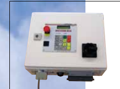
PLC li kontrol kabini ve operatör göstergesi, PLC kabinine entegre
