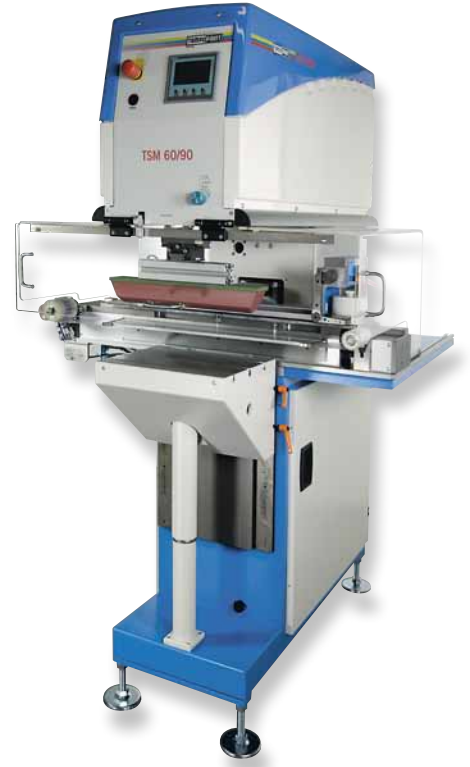
"TSM 60/90" kapalı sistem, enine hazne donanımıyla
