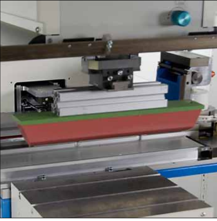
"TSM 60/90", kapalı sistem, enine hazne hareket donanımı
